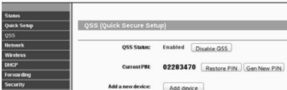
Figura 12.6 – QSS em estado Enabled indica que o protocolo WPS está ativo no roteador.
