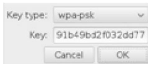
*Figura 8.3 – Inserindo a chave PSK na opção wpa-psk.*
